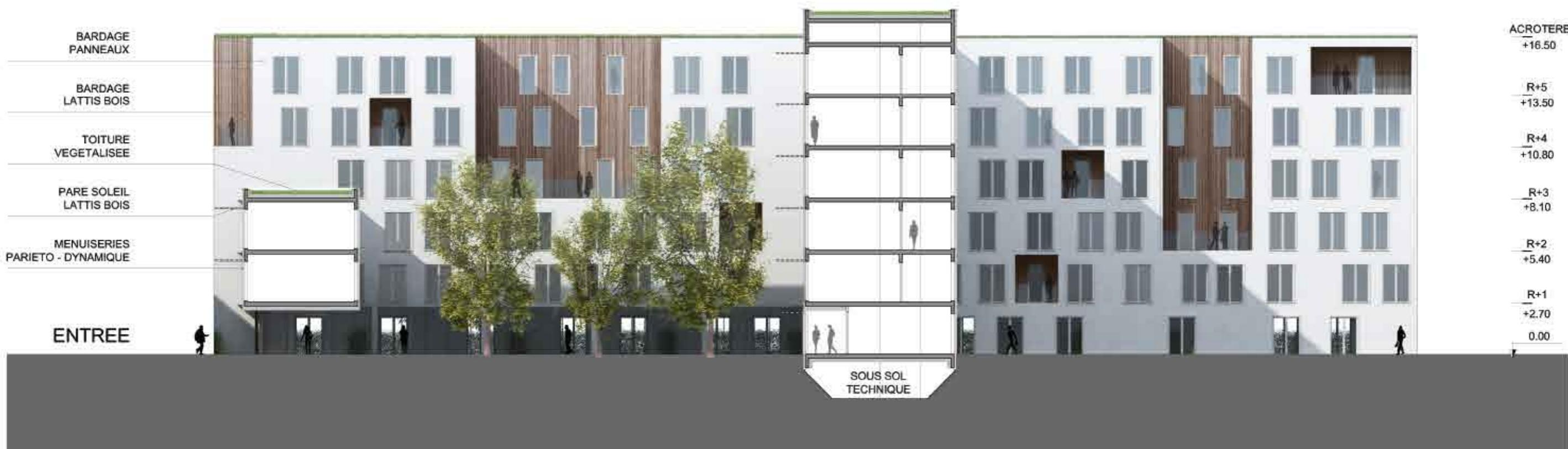
coupe longitudinale sur le cloître: créer une intériorité
